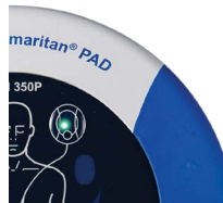
Gambar 11. LED berkedip hijau; tidak memerlukan tindakan apapun.
